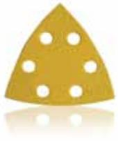
Carta lattice peso C - Resina/Resina - Ossido di Alluminio - Cosparsione Semi-aperta - Stearato
