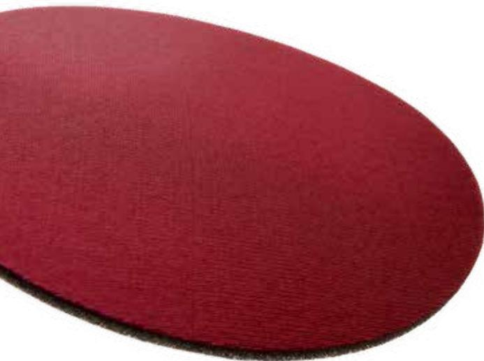
> I dischi Sunfoam sono costituiti da un supporto di gommapiuma morbida accoppiata con Velsystem, con una stesura di abrasivo strutturato. Usati con platorello Velcro dotato di aspirazione, consentono di levigare qualsiasi superficie anche non planare. Il particolare abrasivo strutturato rallenta l'intasamento ed aumenta la finitura.
