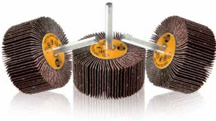
> Le ruote lamellari a gambo sono usate su smerigliatrici portatili. Composte da lamelle di tela disposte radialmente su un nucleo che incorpora il gambo, sono adatte per lavorare particolari di difficile accesso (vani o fori interni) angoli e pezzi di piccole dimensioni.
